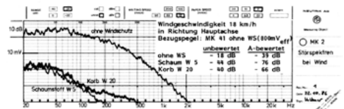
Abb. 7a: Wirkung verschiedenartiger Windschutze auf das Mikrofon CMC 52U (Kugel)
