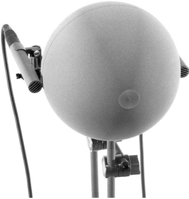
1.g 1990, Geller /10/ Kugel, z.B. Fußball, als Trennkörper, zwischen zwei Druckempfängern
