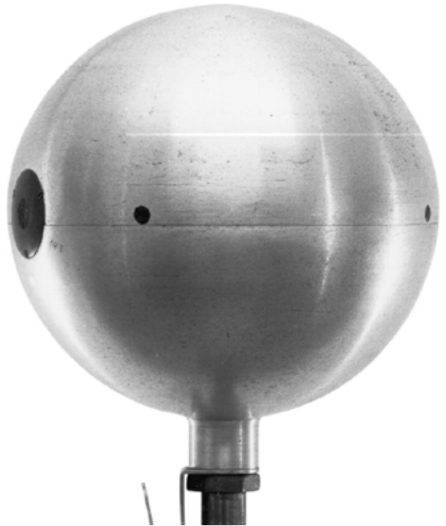
1.b 1955, SCHOEPS-Laborprodukt Aluminium-Hohlkugel mit 20cm Durchmesser mit eingebauten Druckempfängern im Winkel 180°
