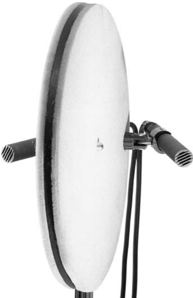
1.d 1980, "OSS", Jecklin-Scheibe /7/ mit absorbierendem Material beklebte Scheibe mit 30cm Durchmesser, mit beidseits im leichten Winkel zueinander angeordneten Druckempfängern
