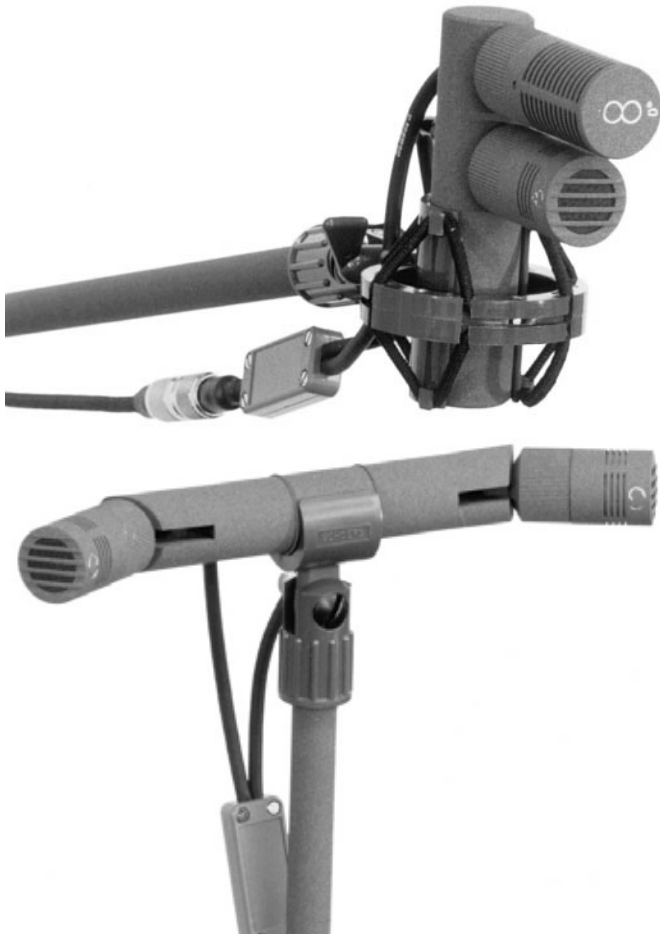
Abb. 2: Einsatz des Y-Kabels, als MS-Einheit (oben) und als ORTF-Mikrofon (unten)
