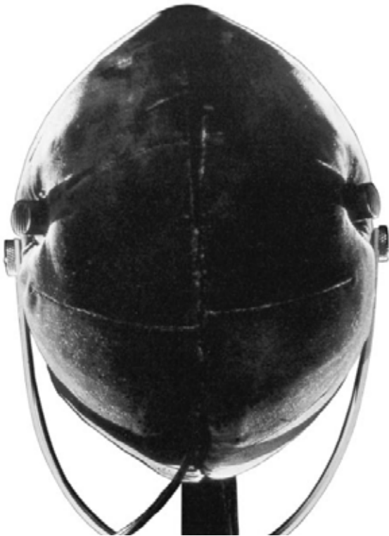
1.a 1954, "Tête Charlin" /6/ mit absorbierendem Material beklebte Kugel mit eingebauten Druckempfängern
