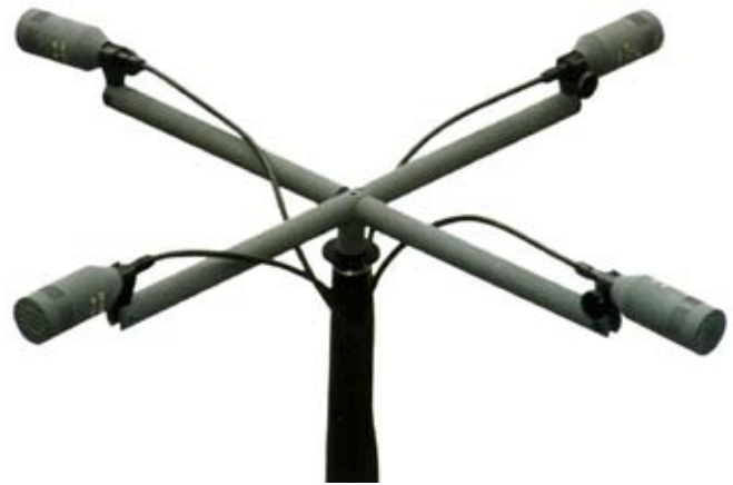
Abb. 1: IRT-Kreuz mit vier Compact-Mikrofonen mit Nierencharakteristik
